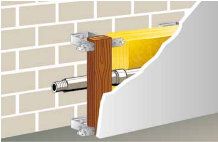
Problemloses Verkleiden von Rohren und Leitungen.
